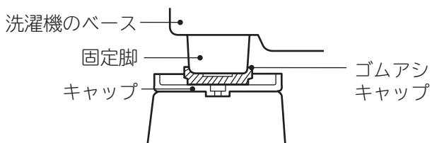
据え付けが終わったら、洗濯機本体の脚が4か所とも確実にキャップの底に接地していることを確認してください。
