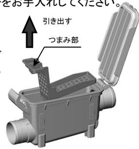
3.フィルターをつまみ部を上にし、フィルター先端部を糸くずボックスの台座部形状にのせるようにして置く。
