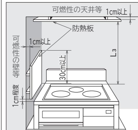
防熱板はこれを設けたとき、機器周囲の可燃物の温度が室温35°Cの時100°Cを越えない断熱性を有すること。
