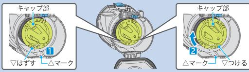
内筒フィルターはしっかり取り付けてください。しっかり取り付けていない状態で本体を運転した 場合、内筒フィルター付近から異音がすることがあります。
