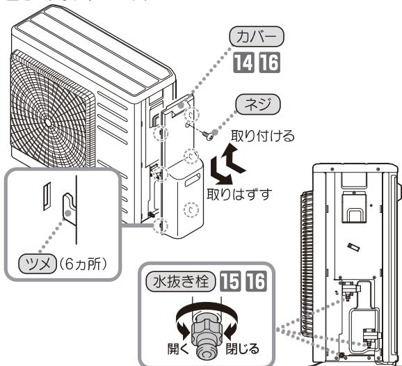
**9** 「水抜き中」が表示されてから、約10秒以上たつたら、漏電しや断器操作力バーをはずし、漏電しや断器の電源レバーを「OFF」にする。
