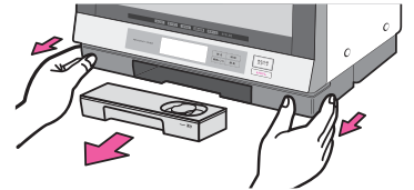
給水タンクを外してから
