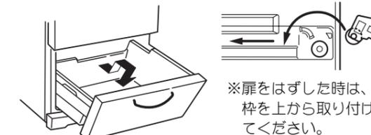
3 下段ケースを図のように持ち上げます。取り付けの際は、ケース左右前側の突起を扉枠の角穴に入れ、ケースふちで枠を抱え込むようにセットしてください。
