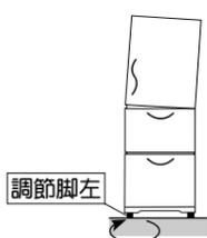
調節脚左を矢印の方向に回して調整してください。
