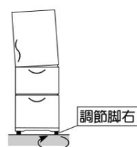
調節脚右を矢印の方向に回して調整してください。
