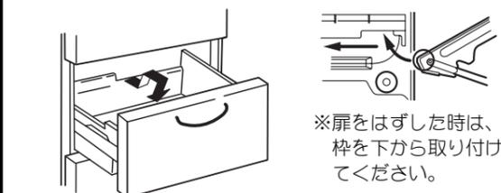
3 野菜ケースを手前に持ち上げます。取り付けの際は、ケース左右奥側の突起を扉枠の角穴に入れ、ケースふちを枠の上に乗せるようにセットしてください。
