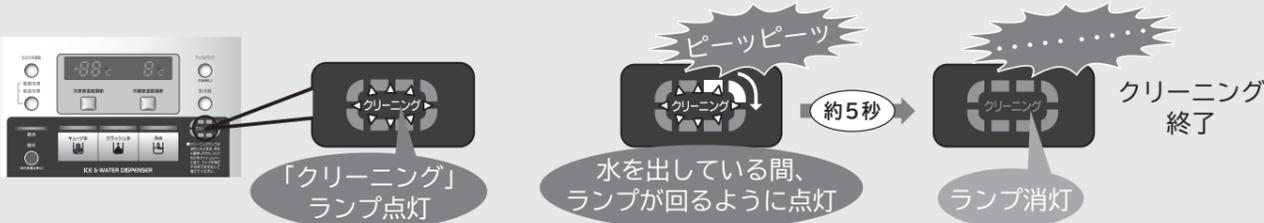
**ご注意** ●「クリーニング」ランプは、ディスペンサーの「冷水」ボタンを押したときに点灯します。「キューブ氷」「クラッシュ氷」ボタンを押すと、「クリーニング」ランプは消灯しますが、「冷水」ボタンを押すと再点灯します。
