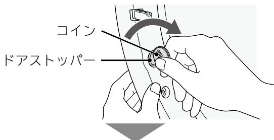
ドアストッパーが飛び出し、固定されます。
