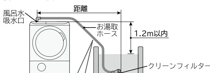
吸水中は、水の重さによりお湯取ホースが垂れ下がり、クリーンフィルターが浮き上がる場合がありますので、垂れ下がりを考慮してホースの長さを決めてください。
