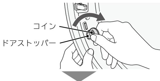
ドアストッパーが飛び出し、固定されます。
