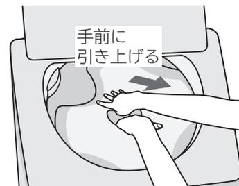
取り付け・取り外しのときは、お洗濯キャップが糸くずフィルターに当たらないように注意してください。
