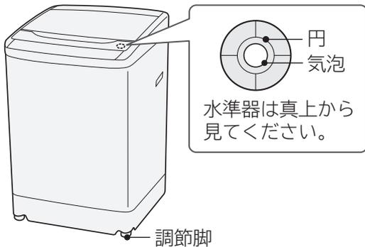
**3** 水準器の気泡の位置に応じて、固定脚に付属品の脚キャップを取り付ける (調節脚は回して高さを調節します)
