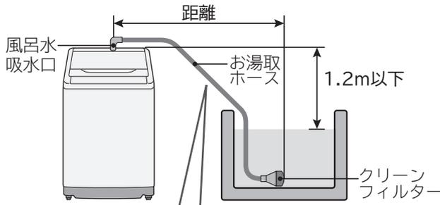
吸水中は、水の重さによりホースが垂れ下がり、クリーンフィルターが浮き上がる場合がありますので、垂れ下がりを考慮してホースの長さを決めてください。
