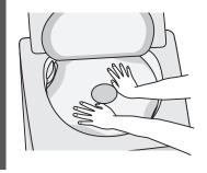
9 中央リング部を持って、 バランスリングのすぐ 下まで引き上げる 中央リング部 バランスリング
