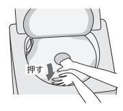
中央リング部を図のように 持ち、矢印の方向に曲げる
