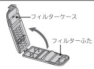
3 糸くずフィルター内に付着している 糸くずを取り除き、目詰まりを洗い 落とす
