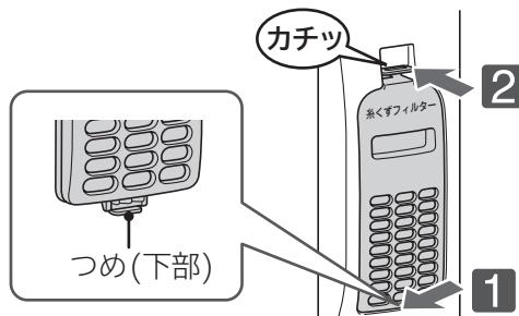
●糸くずフィルターを取り外したあとの洗濯・脱水槽の穴に、ヘアピンや硬貨などを落とさないように注意してください。
