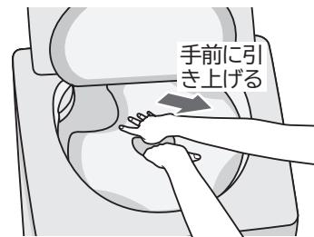
お洗濯キップの取り付け・取り外しのときは、お洗濯キップが糸くずフィルターに当たらないように注意してください。糸くずフィルターが外れたり、破損したりするおそれがあります。
