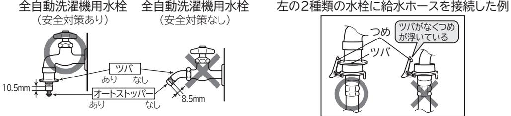
※オートストッパー付きは、給水ホースが外れると、水漏れ防止のため給水を自動でストップします。
