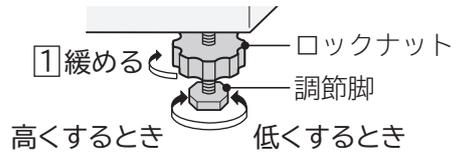
**2** 調節が終わったら、ロックナットを矢印方向 **②** に「カチッ」と2回以上音がし、回らなくなるまで回して固定する
