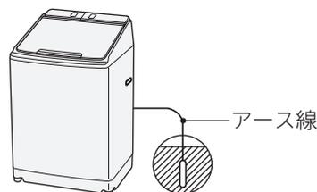
(電気工事士の有資格者がD種(第3種)接地工事をするよう、法令で定められています)
