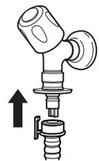
※オートストッパー付きは、給水ホースが外れると、水漏れ防止のため給水を自動でストップします。
